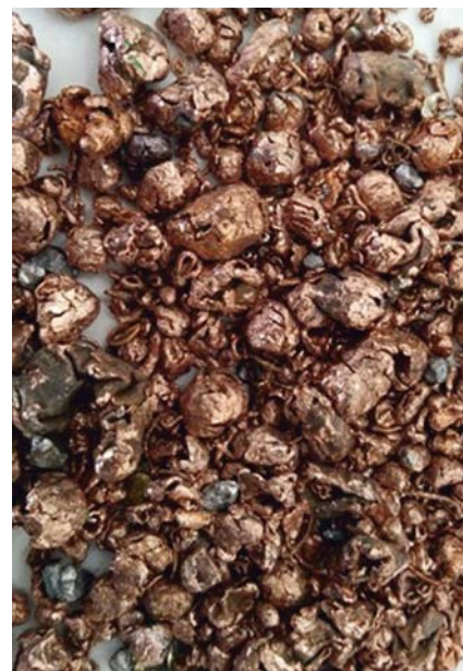
Verkugelmühle Sicon EcoShred ImTec und das Endprodukt: verkugelt Kupfer
