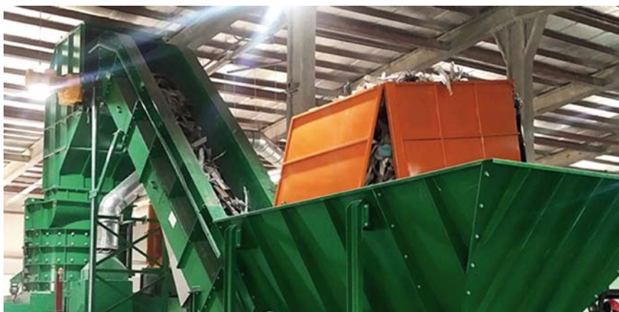
Aufbereitungslinie von Sicon für Meatballs, Elektromotoren und andere Metallverbundstoffe
