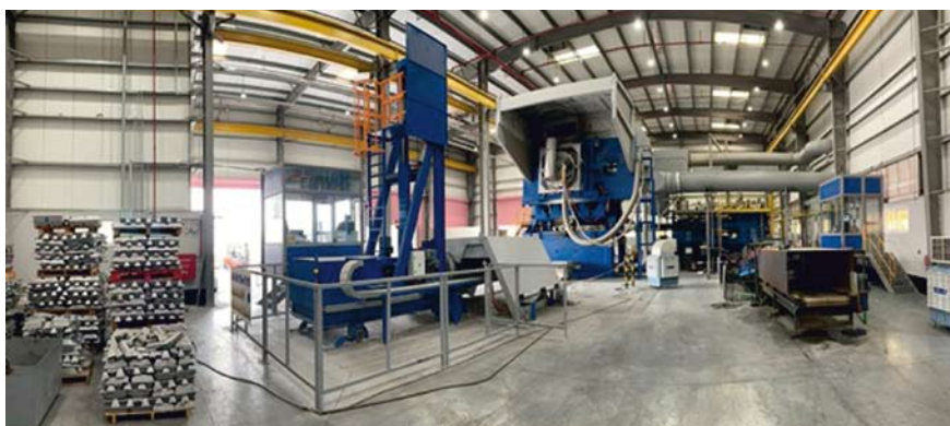
Schmelzanlage für Aluminium in Doha
